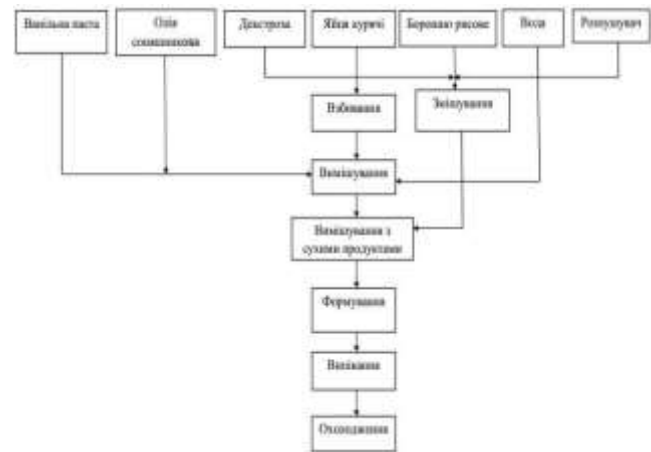
Рис. 1 Технологічна схема приготування бісквіту на рисовому борошні
