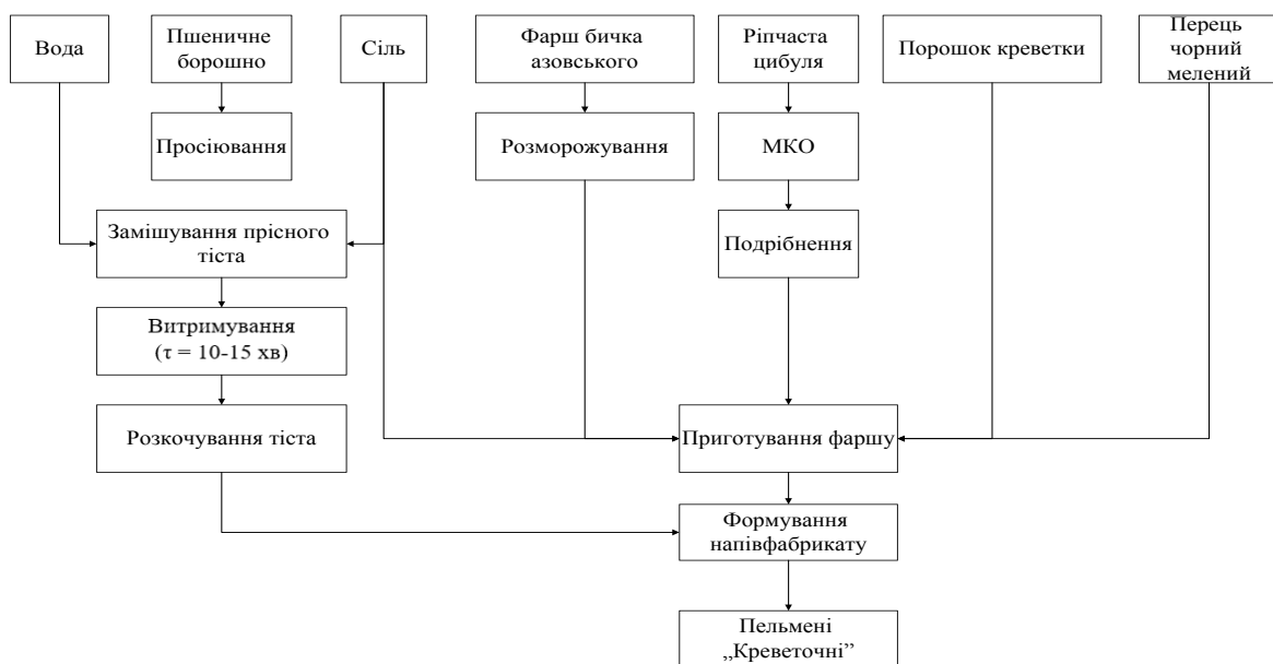
Рис. 2. Технологічна схема борошняного кулінарного виробу – пельмені «Креветочні»
